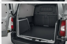
Zabudowa ścian bocznych i nadkoli - prawe drzwi przesuwne Zabudowy przestrzeni ładunkowej
